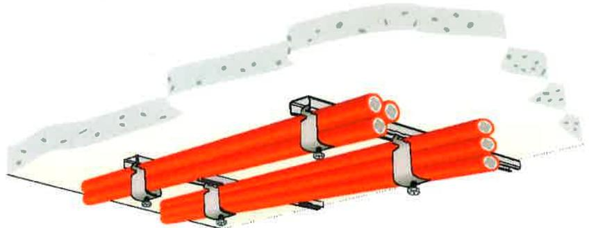
**Tragsystem:** Bügelschelle oder Bügelschelle mit Langwanne an C-Schiene
