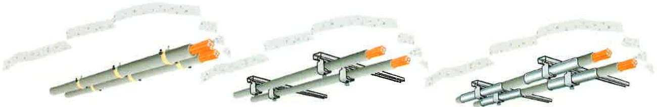
**Tragsystem:** Halogenfreies Kabelschutzrohr oder Aluminiumschutzrohr nach DIN EN 61386-21 in Einzelschelle oder Bügelschelle sowie Bügelschelle mit Langwanne, an C-Schiene bzw. mit Dübel
