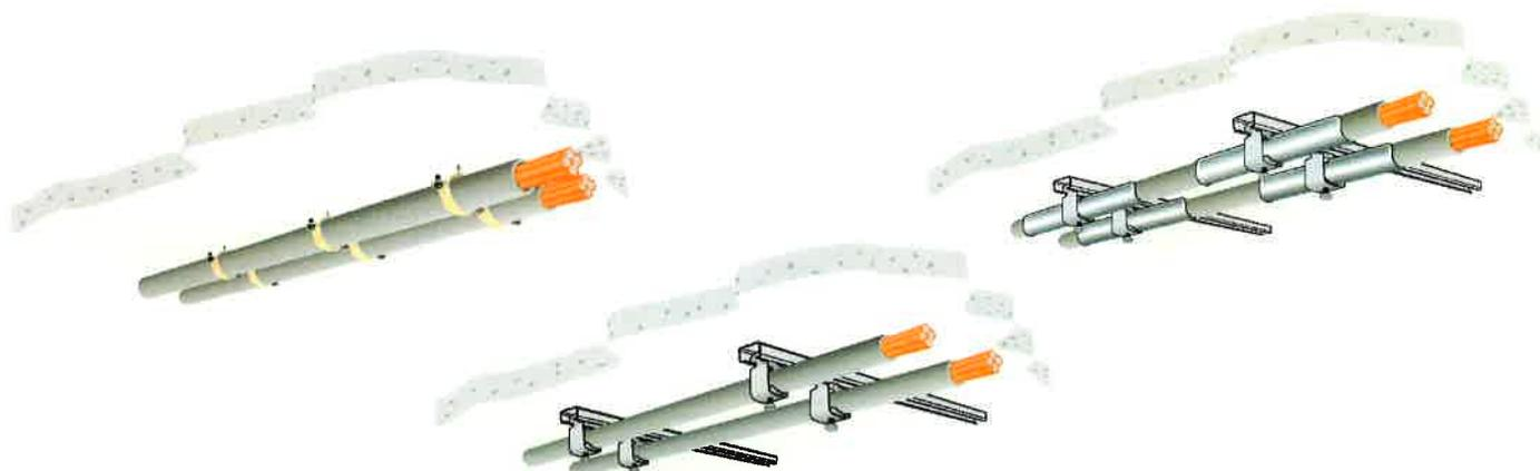
**Tragsystem:** Stahlpanzerrohr nach DIN EN 61386-21;  $\leq \varnothing 63$  mm in Einzelschelle oder Bügelschelle sowie Bügelschelle mit Langwanne, an C-Schiene bzw. mit Dübel
