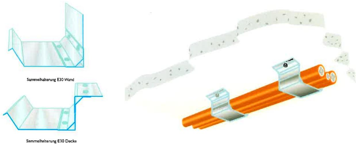
**Tragsystem:** Sammelhalterung Dätwyler, Typ „SHD-D“ für Deckenbefestigung bzw.
